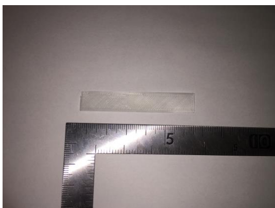
図4 造形後の形状記憶ポリマーシートの形状
