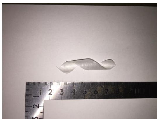
図 6 完全に形状回復したポリマーシート
